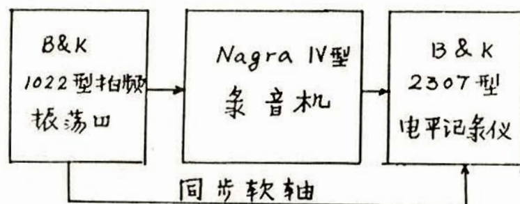
附图 5. 录音机频响曲线测试原理
