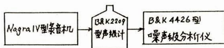
图 4-13. B&K 4426 型噪声级分析仪分析原理
